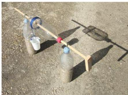
Bouteilles plastique, sable, pitons pour le support. Bouteille plastique, tasseau de section carrée (axe), ficelle, gobelet, tasseau et clou pour la manivelle...
