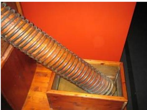
Cylindre (tube PVC) sur lequel on entoure un tuyau plastique souple (type durite ou gaine pour fil électrique), fixation par scotch fort (type chatterton) ou ficelle.
